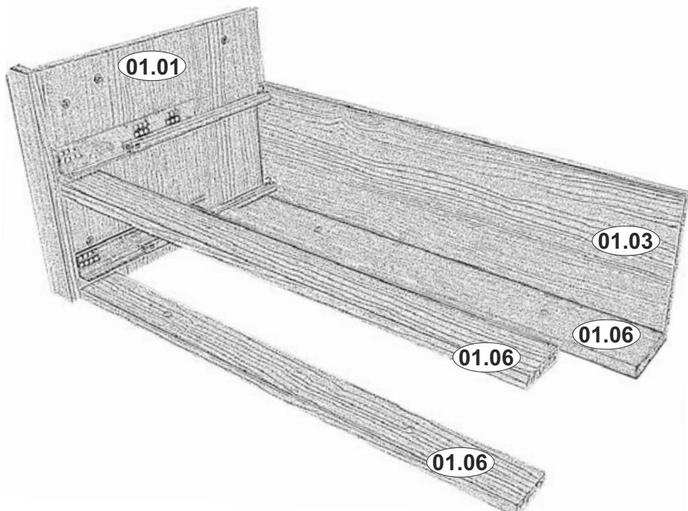
К собранной конструкции приставить стенку вертикальную 01.02. Крепить стенку 01.02 к стенке вертикальной 01.03 и планкам 01.06 на евровинты при помощи отвертки. На евровинты установить заглушки
