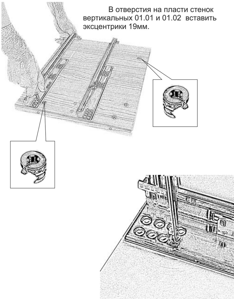
Вертикальные стенки тумбы 01.01 и 01.02 оборудовать направляющими, как показано на рисунке. Совместить 4 и 10 отверстия на механизме с отверстиями на стенках вертикальных. Вставить винты 6,3x10 в отверстия и завернуть их по часовой стрелке до упора.
