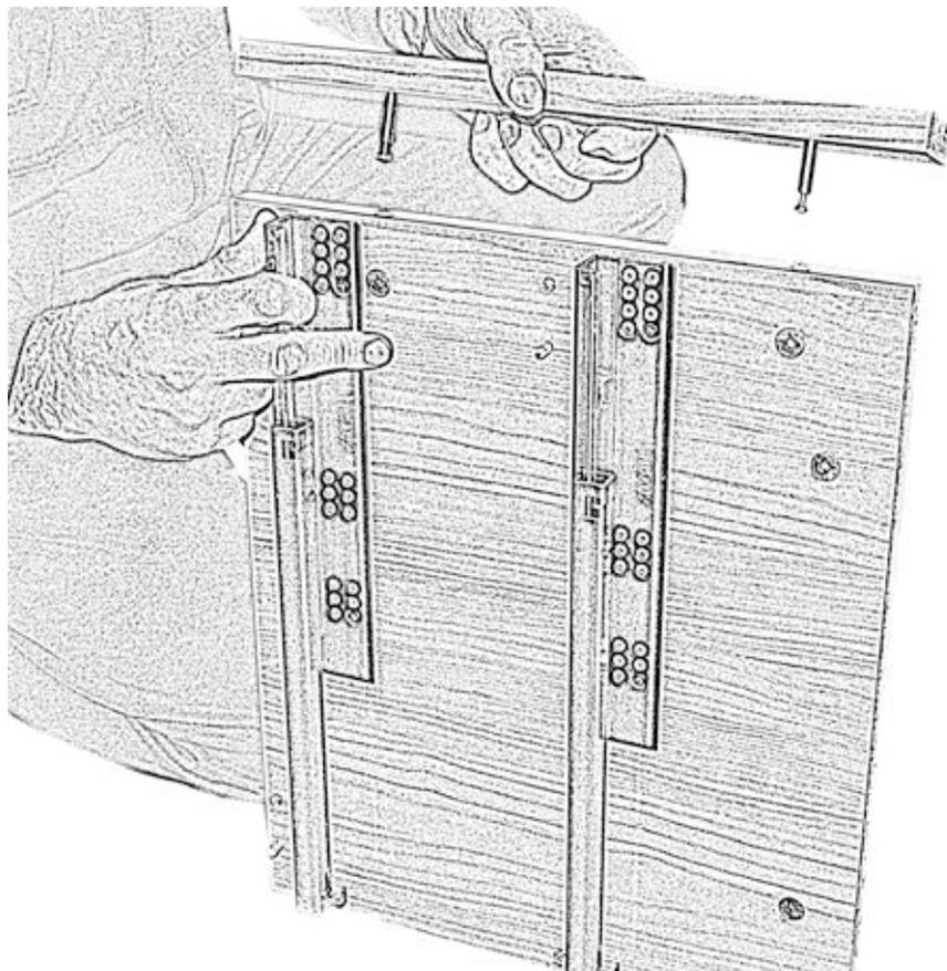
В отверстия на краях планок 01.06 вставить по два шканта.
