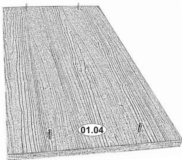
Приставить стенку горизонтальную (крышку) 01.04 соединительными винтами к отверстиям на кромках стенок вертикальных 01.01 и 01.02. Крепить крышку к корпусу тумба на эксцентрик-овую стяжку при помощи отвертки. На эксцентрики установить заглушки.
