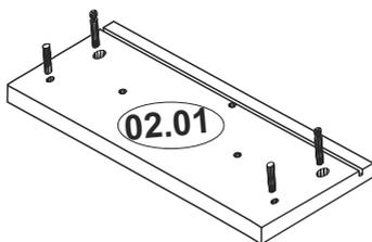
Установить шканты в отверстия на кромке задних стенок ящиков 02.04.
