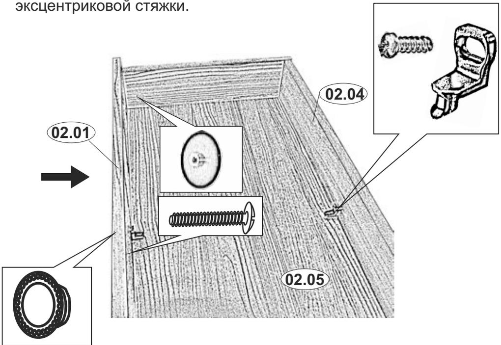
Закрепить донья ящиков 02.05 к передней 02.01 и задней 02.04 стенкам при помощи держателя заднего щита на винт 6,3x10. В шлицы эксцентриков вставить заглушки. На передние стенки ящиков установить на винты ручки и зафиксировать при помощи отвертки. При необходимости подложить шайбы.
