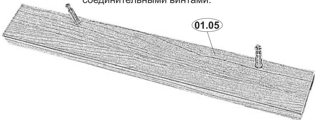
Оборудовать стенки вертикальные 01.01 и 01.02 вертикальными планками 01.05 и закрепить на эксцентриковую стяжку.
